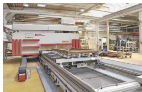
Kratzband- und Querförderer sowie die kraftvolle Absaugung halten die Maschine sauber.
