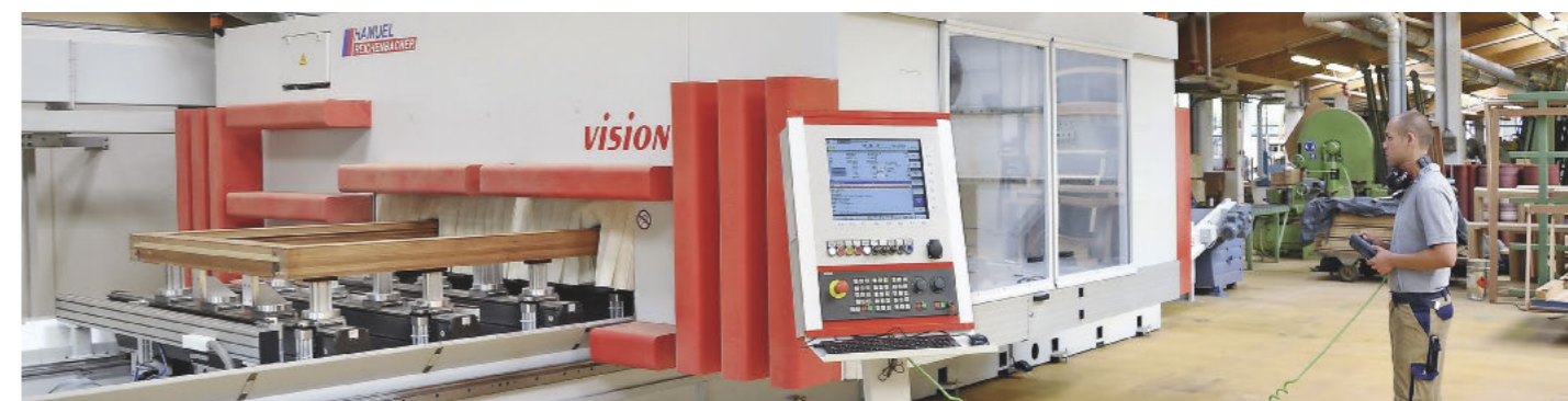
/ Nur ein Bediener stellt den Rahmen für eine Brandschutztüre mit sämtlichen erforderlichen Fertigungsschritten in rund 25 min her. Das 5-Achs-Bearbeitungszentrum Vision-III-T-U haben die Ingenieure von Reichenbacher exakt und sehr individuell auf die besonderen Anforderungen von Hoba hin konzipiert.
