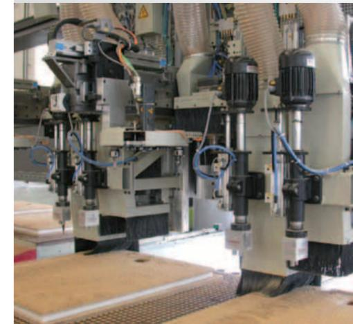
Sechs Vertikalfräsaggregate und vier Vertikalbohr-einheiten sind auf der Portalvorderseite auf zwei, über NC-Achsen zueinander verstellbaren, getrennten Aggregatträgern angeordnet. Vor den zwei Frässpindeln mit automatischer Werkzeugwechseleinrichtung ist je ein automatisches 10-fach Teller-Werkzeugmagazin angebracht und ermöglicht einen Werkzeugwechsel während der Fräsbearbeitung.
