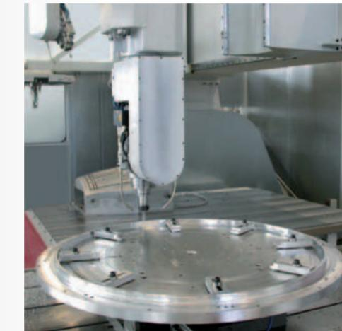
Speziell für die hohen Anforderungen der Flugzeugindustrie ist diese ECO mit zwei T-Nutentischen aus Stahlguss sowie einem NC-Rundtisch für Präzisions-Drehfrästeile ausgelegt. Für die Bearbeitung von großen Teilen können die Maschinentische elektrisch gekoppelt werden.
