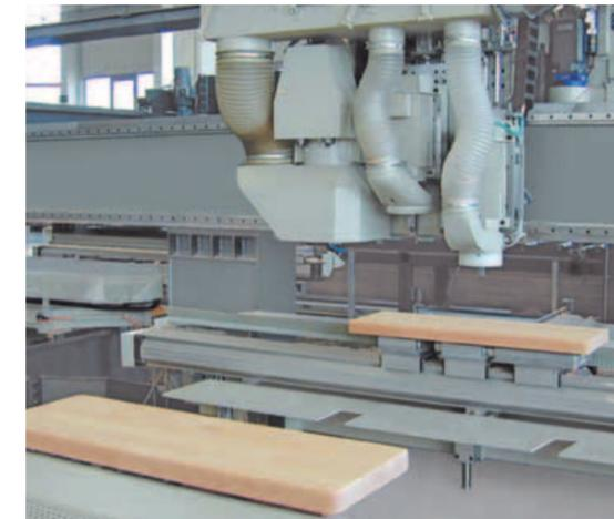
Als Maschinentisch sind vier Auflagerträger in X-Richtung angeordnet. Pro Beladestation gibt es zwei bewegliche Träger und pro Träger sind fünf, über NC-Achse motorisch verstellbare, Vakuumsauger im Einsatz. Vor der Verstellung der Sauger werden diese auf eine Referenzposition „auf Block“ zusammengefahren und von dort aus im Schleppverband wieder neu positioniert.
