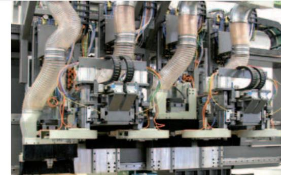
Diese vier Arbeitsaggregate mit automatischem Werkzeugwechsel für vertikale Fräs-, Bohr-, Säge- und Schleifarbeiten, inklusive Kühlstrahl- und Schmiergerät, sind zum Bearbeiten von Aluminium ausgelegt. Vor jeder Frässpindel ist ein automatischer Tellerwechsler für 10 Werkzeuge angebracht, der auf der Querachse mitfährt.
