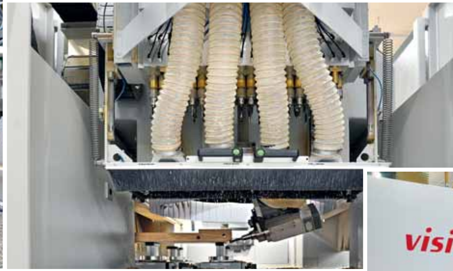
Links der automatische Kettenwechsler für 40 Werkzeuge, unten der 40-fach Bohrkopf (im Hintergrund das 5-Achs-Aggregat bei der Bearbeitung)
